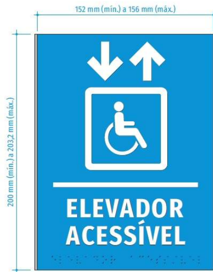
Figura 36 – Modelo de placa de sinalização visual em relevo e Braille para identificação de elevadores
