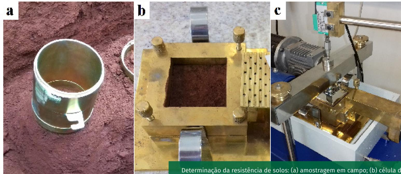
Determinação da resistência de solos: (a) amostragem em campo; (b) célula de cisalhamento com corpo de prova; e (c) ensaio de cisalhamento direto em laboratório.
