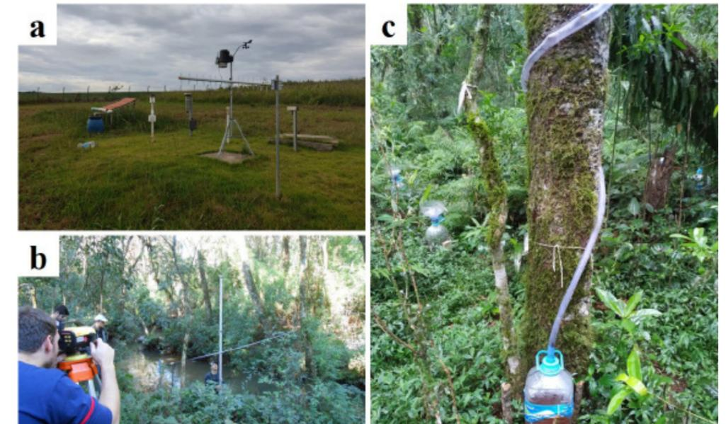
Monitoramento hidrológico: (a) Estações meteorológica e pluviométrica e telhado experimental; (b) Levantamento de seção transversal para estudos de geomorfologia fluvial; e (c) Intercepção da água da chuva pela floresta.
