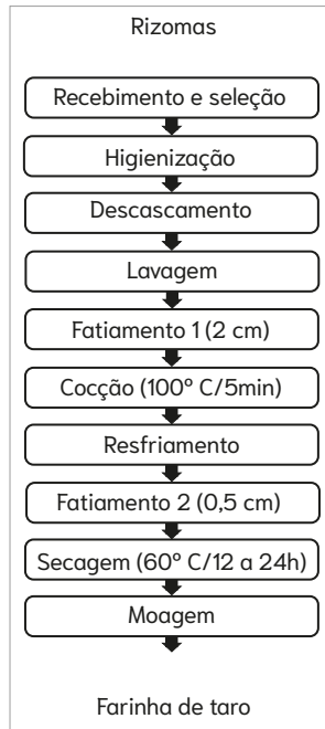
Figura 3 —Etapas para processamento dos rizomas e produção da farinha de taro
