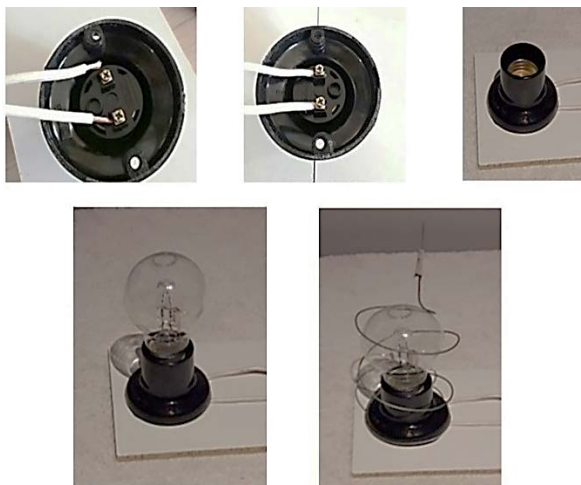
Figura 124 – Montagem da parte elétrica do experimento “abajur giratório” (soquete e arame)
