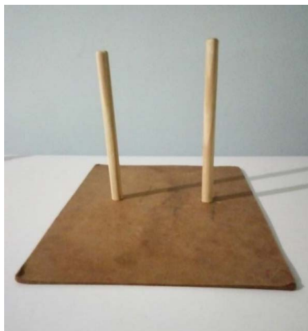
Figura 92 – Cabo de vassoura já cortado e colado na base do suporte do alto-falante
