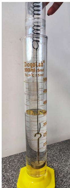
Figura 63 – Latão suspenso pelo dinamômetro e submerso na água para determinar o seu peso aparente
