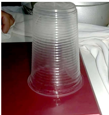
Figura 112 – Copo já com o etanol espalhado em seu interior colocado com sua abertura voltada para baixo sobre a superfície lisa e plana
