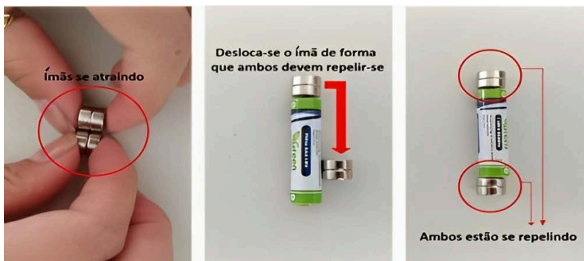
Figura 147 – Acoplamento dos ímãs de neodímio à pilha
