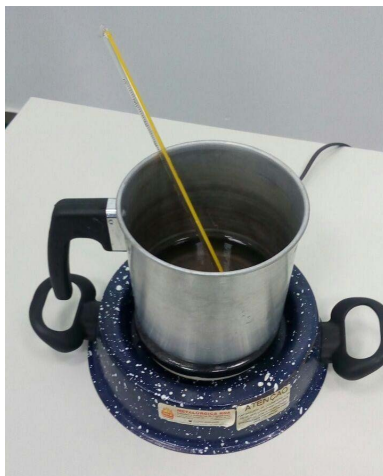
Figura 121 – Medição da temperatura da água em aquecimento
