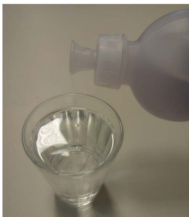
Figura 66 – Agulha submergindo após ser despejado um pouco de detergente na água
