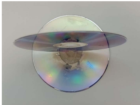
Figura 195 – Montagem do suporte em que será fixado o fio de cabelo (imagem vista de cima)
