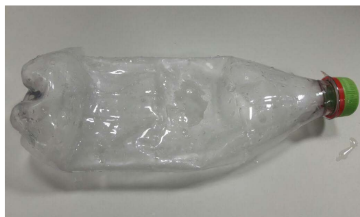
Figura 115 – Garrafa comprimida devido à diminuição da pressão interna
