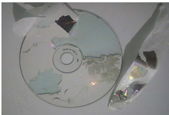
Figura 191 – Remoção do revestimento metálico do CD com a fita crepe
