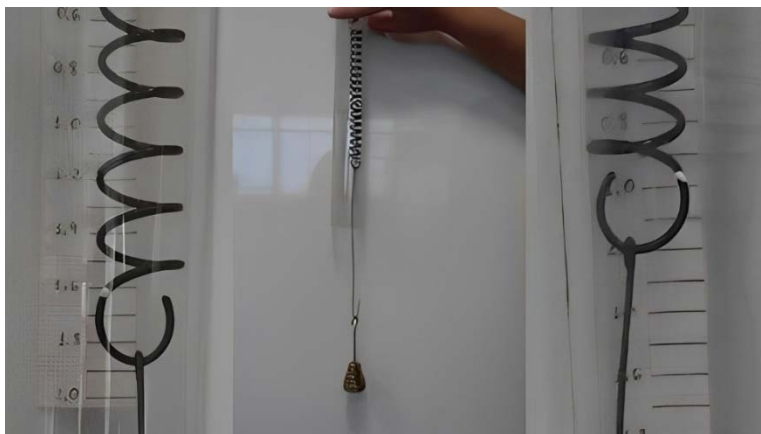
Figura 42 – Observação de como medir o peso utilizando o ponto de referência no dinamômetro
