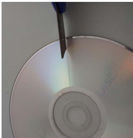
Figura 190 – Corte no revestimento metálico do CD
