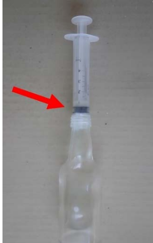
Figura 104 – Junção entre a seringa e o recipiente de vidro que deve ser envolta de cola
