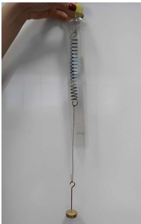
Figura 62 – Latão suspenso pelo dinamômetro no ar para determinar o seu peso
