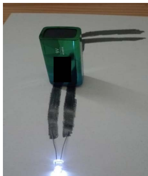
Figura 152 – Lâmpada LED alinhada e bateria alinhada na trilha de grafite, com o LED mais distante
