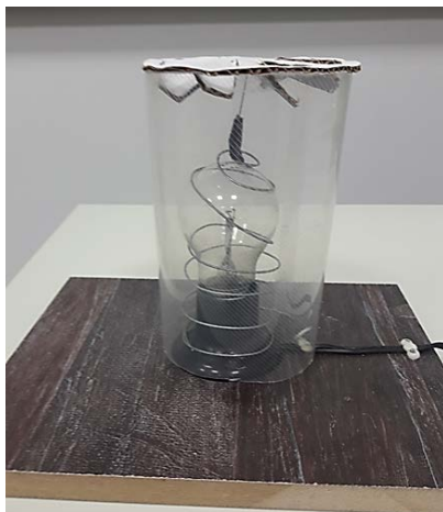
Figura 125 – Montagem do experimento “abajur giratório”
