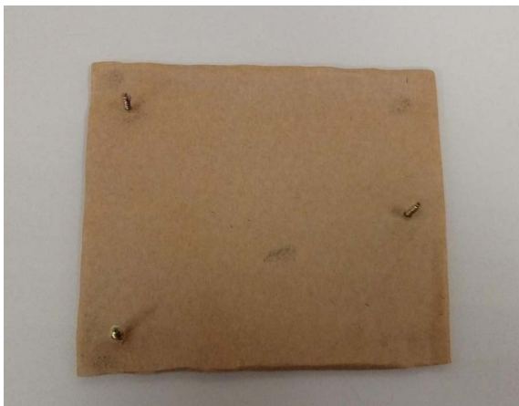
Figura 2 – Parafusos fixados no suporte de madeira formando um triângulo
