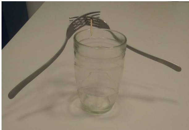
Figura 27 – Experimento “centro de gravidade” em funcionamento
