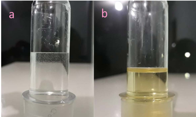
Figura 74 – Análise dos meniscos no recipiente de plástico com (a) água e (b) óleo de soja
