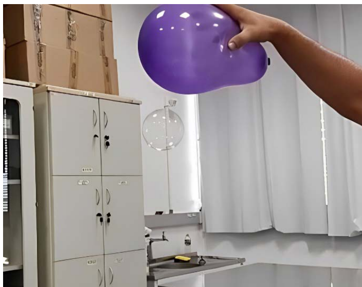
Figura 132 – Bolha suspensa em ponto de equilíbrio entre força peso (da bolha) e força de atração exercida pelo balão
