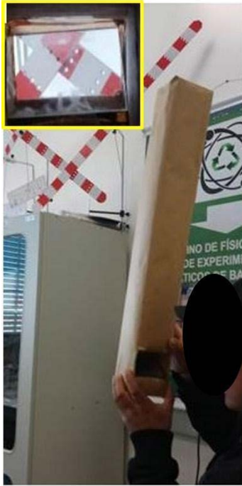
Figura 175 – Periscópio em uso, com destaque para a imagem visualizada pelo observador no espelho
