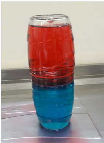
Figura 59 – Experimento em funcionamento, com água quente em cima e água fria embaixo
