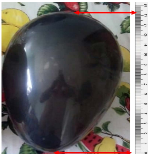
Figura 101 – Medição de uma das dimensões do balão resfriado no congelador (0,144 metros)
