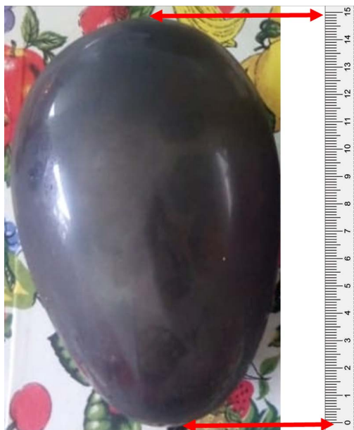
Figura 102 – Medição de uma das dimensões do balão que se encontra em temperatura ambiente (0,149 metros)
